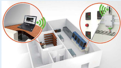
화재평가 시험기기 제작에 사용되는 시험용 챔버 온도조절기의 통신에 적용된 'SCM-WF48'
