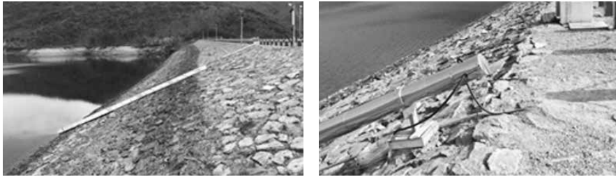
그림 6. 경사면에 다굴절로 적용한 음향 수위계(50m, 23°)
