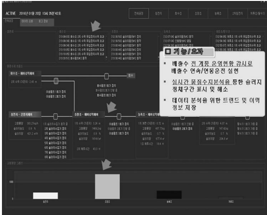
그림 4. 배출수 공정 실시간 물질수지 분석을 위한 메인 화면
