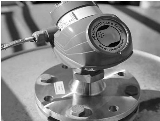
그림 4. 상거래용에 사용되는 자동 게이징 시스템은 밀도 계산을 위한 자동화 온도 측정을 포함한다.
