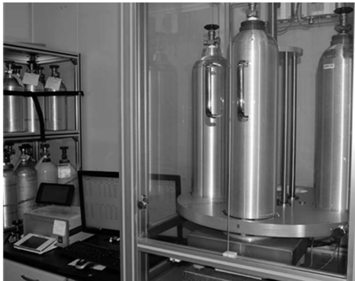
KRISS에서 개발하여 해외 5개국에 수출한 '표준가스 제조용 전자동 무게 측정기술' 장비. 우측 장비에 가스가 들어있는 시료실린더/기준실린더를 장착한 뒤, 왼쪽 화면을 통해 질량을 측정 및 비교할 수 있는 전자동 시스템
