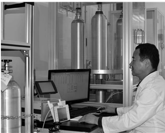
'표준가스 제조용 전자동 무게 측정기술'을 통해 가스의 질량을 측정하고 있다.
