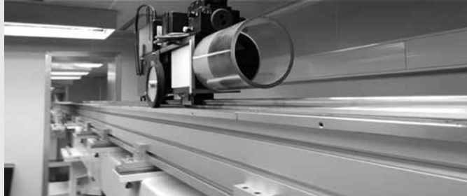
KTL 향온항습실 내 45m 기선장 및 타겟 이동용 자동로봇 / KTL 경기분원
