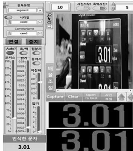
영상을 이용한 토크 측정기 교정 자동화 시스템 분석 장면 / KTL 경기분원
