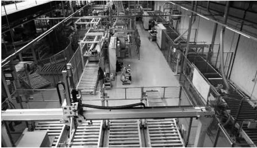
그림 1. 주변 이미지 “유연한 도어 리프 생산”, 전체 시스템 다양한 디자인, 다양한 크기 및 다양한 자재를 사용하는 도어 리프 주문 생산. Bürkle는 매우 유연하고 미래 지향적인 시스템으로 평가되는 까다로운 생산 시설 프로세스를 구현했다.
