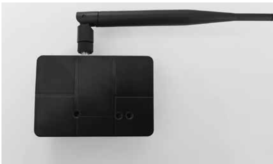
라즈베리파이를 이용하여 무선 및 RS485 TO 이더넷 구현이 가능한 장치를 만들었다.
