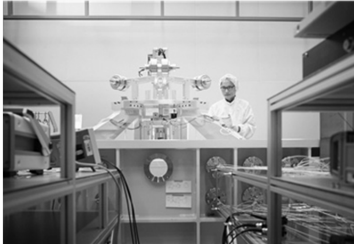
KRISS에서 새로운 킬로그램 표준을 확립하기 위해 개발중인 '키블 저울' - 키블 저울(Kibble Balance) : 변하지 않는 기본상수 '플랑크 상수(h)'를 통해 킬로그램(kg)을 정의하는 장치
