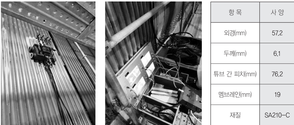
그림 4. 유동층 보일러 수냉벽 튜브 원격 육안검사 사전 시험
