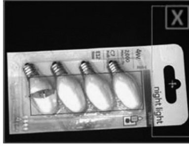
〈그림 11〉 전구 패키지를 검사하여 4개 전구가 모두 존재하고, 깨진 전구가 없는지 확인
